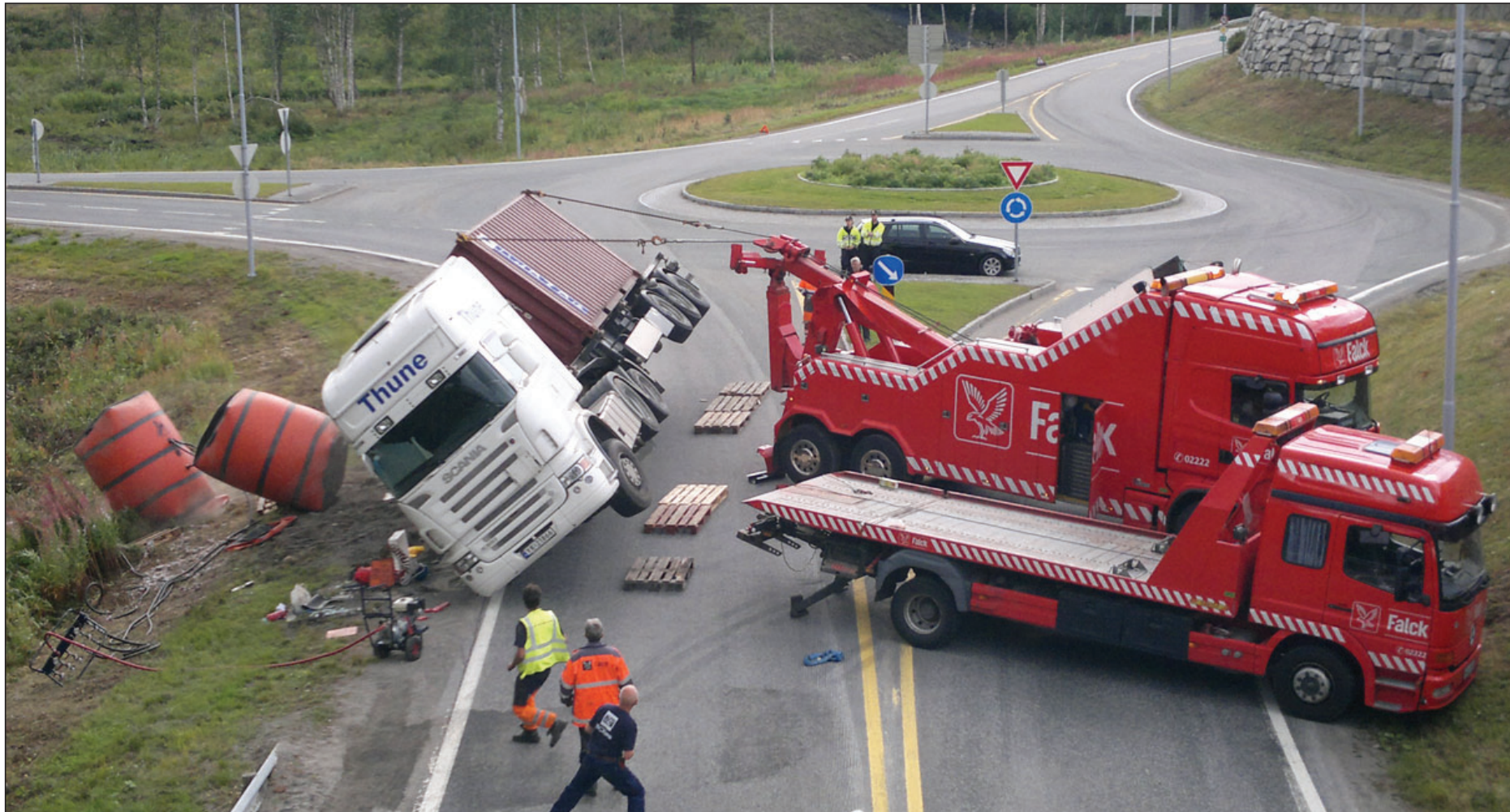
TUNGT LASTET: Semitraileren var lastet med 24 tonn stålwiretromler. Det ble derfor en krevende oppgave å få den på rett kjøl igjen. Det ble blant annet brukt luftputer i bergingsarbeidet.
